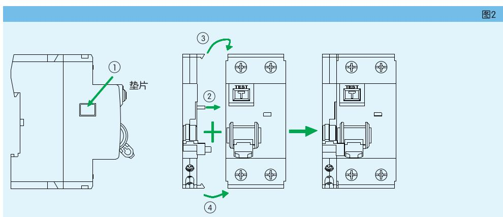
5.2 辅助触头与NL1剩余电流动作断路器拼装后，一起安装在TH35-7.5型钢安装轨上。
